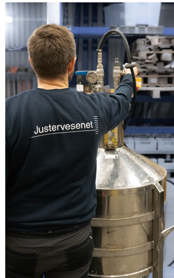
Fra Justervesenets tankbilhall: Kontroll av måleinstrumenter som brukes til å måle væsker.
