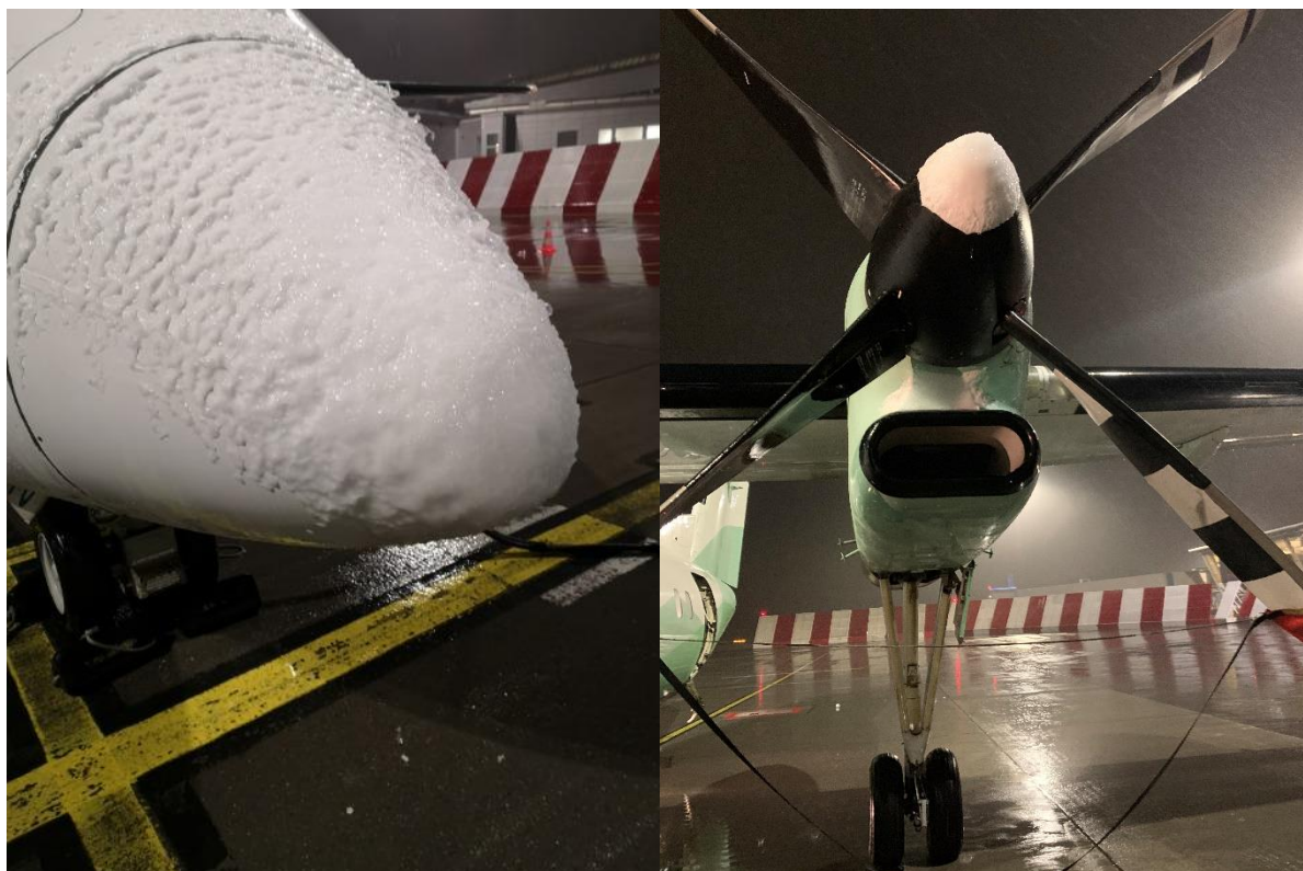
Gjenværende is på nese, spinner og området mellom luftinntak og spinner. Isen har blitt hengende til tross for at det var 8 °C og regn på flyplassen. Foto: Fartøysjef WF577
