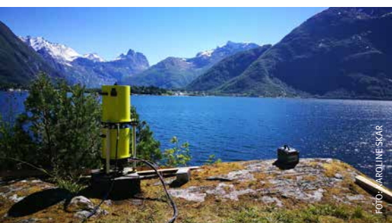
FELTARBEID OM SOMMAREN. TYNGDEMÅLINGER MED ABSOLUTT GRAVIMETER.
