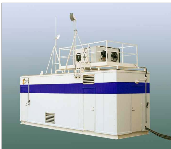
Figur 5.3. Elektrolyser i container installert i Reykjavik og Hamburg 2003. Elektrolysørene er levert av Norsk Hydro Electrolysers AS og betjener hver 3 brenselcellebusser. Kapasitet på 60 Nm 3 /h, 15 bar.
