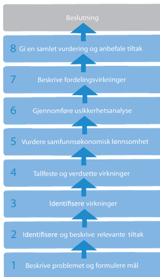
Figur 3.2 Flytdiagram for gjennomføring av samfunnsøkonomisk analyse
