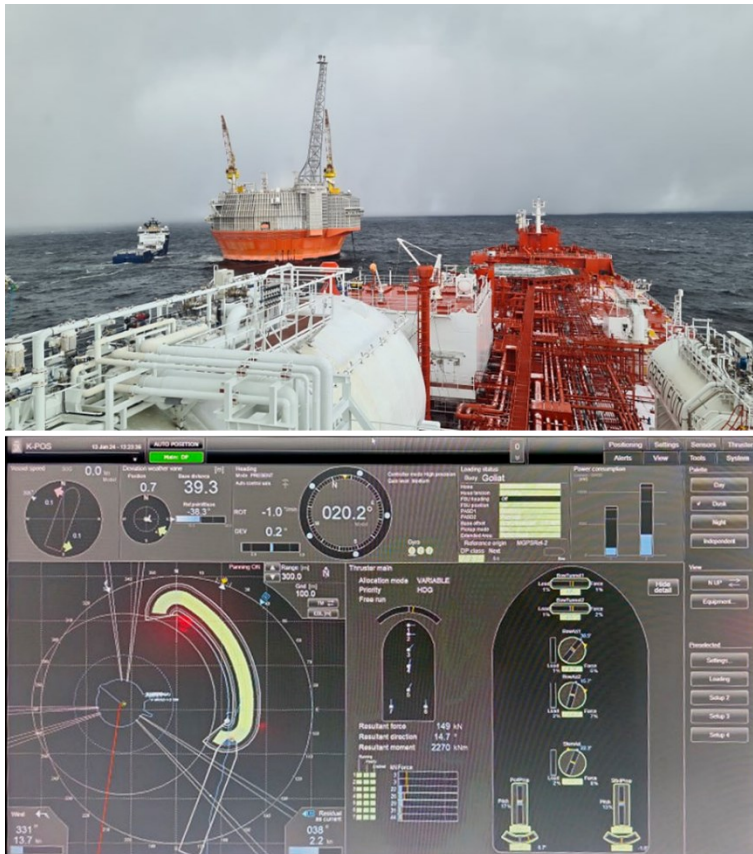
Figur 6-3. Shuttle-tanker under lasting ved Goliat. Under er vist skjermbilde av samtidig DP-display, hvor skipet ligger i "weather vaning". Navigasjonssystemene GNSS, DARPS, XPR, Radius og HPR/Hipap benyttes som posisjonsreferanse. Beredskapsbåten som alltid er lokalisert i nærheten av Goliat, her øverst t.v. i bildet, spiller en viktig rolle i overvåking og beredskap i området rundt plattformen. Det er fartøyene Esvagt Eurora og Stril Barents som i dag har denne rollen, her representert med Stril Barents (illustrasjon utarbeidet av Norvald Kjerstad, NTNU).
