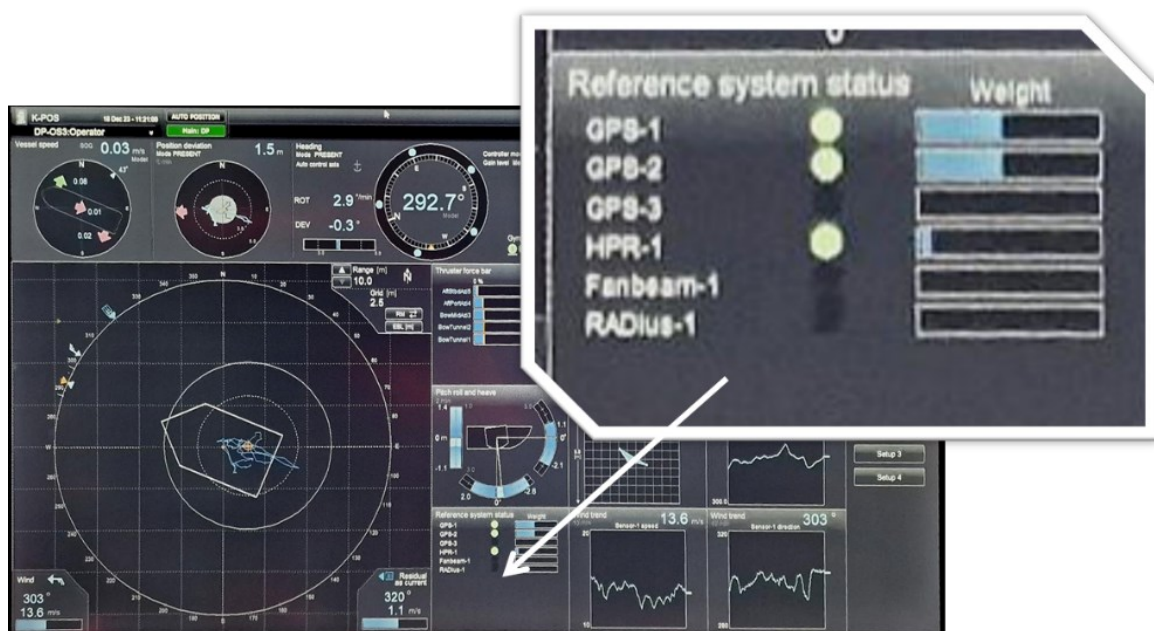
Figur 6-9. Visning av tre benyttede posisjonsreferansesystemer på DP-display under operasjon av survey fartøy ved Goliat-feltet (illustrasjon utarbeidet av Norvald Kjerstad, NTNU).
