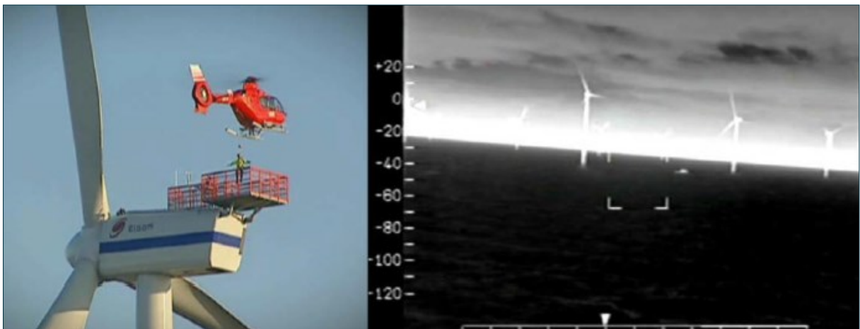
Figur 6-12. Helikopter benyttes rutinemessig i offshore vindkraftverk for frakting av vedlikeholds-personell. Til høyre vises IR-bilde av et vindkraftverk sett fra helikopter (illustrasjon hentet fra Vestas og MCA).
