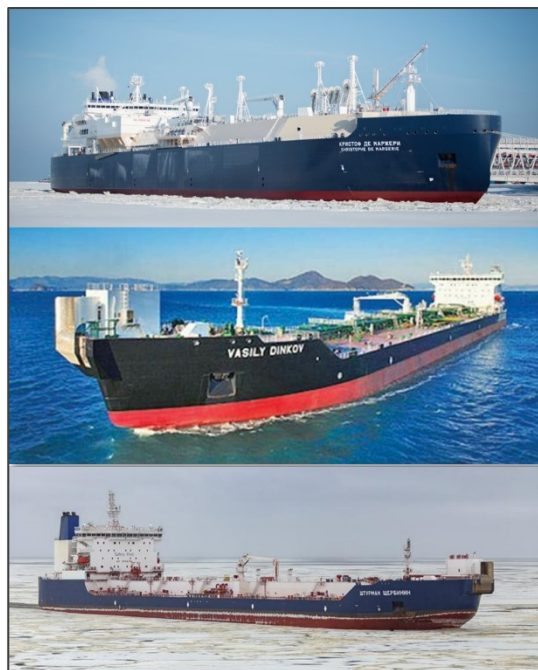
Figur 3. Eksempel på de største skipene. Alle med høy isklasse og azimuth-thrustere. Øverst Sabetta-klasse LNG-tanker med 299 meter lengde og 3 x 15 MW fremdrift. I midten, Varandey-shuttle tanker med lengde 257 meter og 2 x 10 MW fremdrift. Nederst Ob-gulf shuttle tanker med lengde 249 meter og 2 x 11 MW fremdrift.
