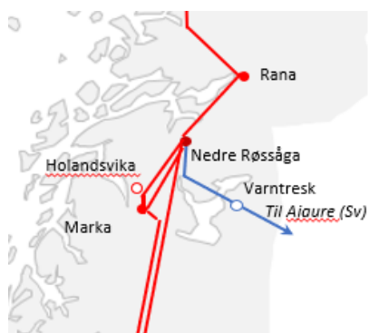
Figur 32: Konsept 5 - Ny 420 kV Nedre Røssåga - Marka og forskuttet spenningsoppgradering fra Nedre Røssåga til Midt-Norge.
