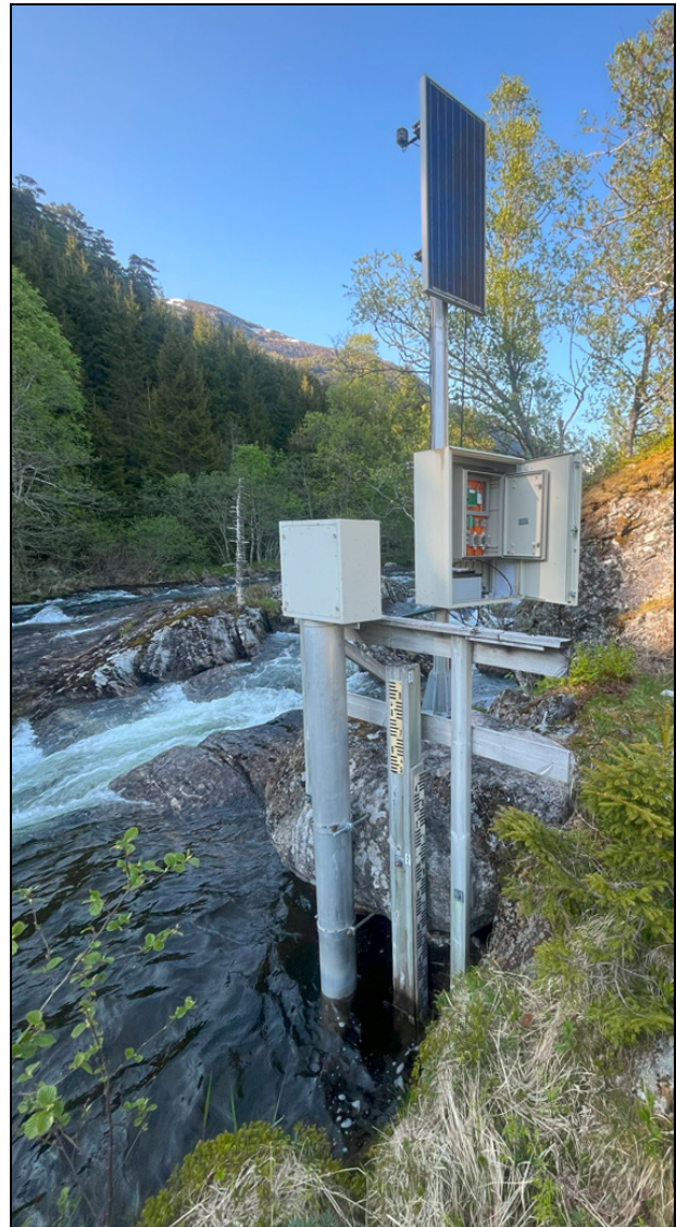
Figur 8.2 Hydrologisk målestasjon i Nessedalselv i Høyanger kommune.
