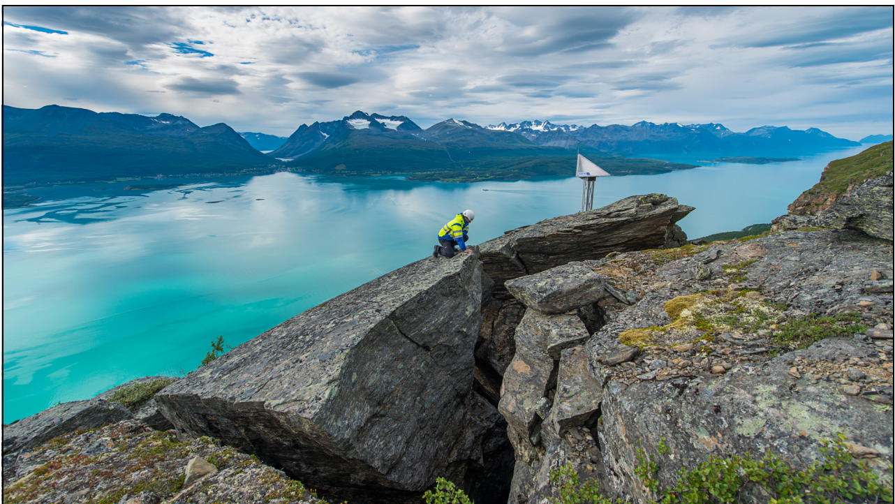
Figur 8.4 Måling av rørsler på ustabil fjellparti, Jettan, i Kåfjord kommune.
