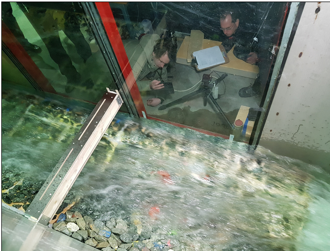
Figur 14.1 Modellforsøk med erosjonssikring i vassdragslaboratoriet på NTNU.
