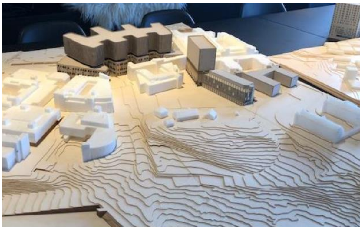
Figur 30: Bilde av fysisk modell. Illustrerer veiløsning med minst mulig inngrep i terrenget ved å legge vei rundt østsiden av Lindekollen.
