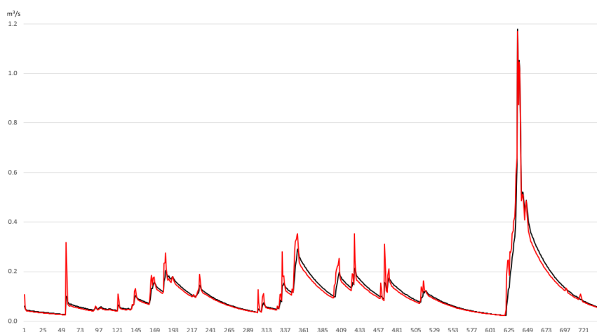
Figur 4.7.4. Simulert vannføring Tistilbekken før (svart strek) og etter (rød strek) urbanisering noen dager i desember 2020 (timesdata). Vannføringer er beregnet med DDDurban og nedbørinput fra SeNorge V2.
