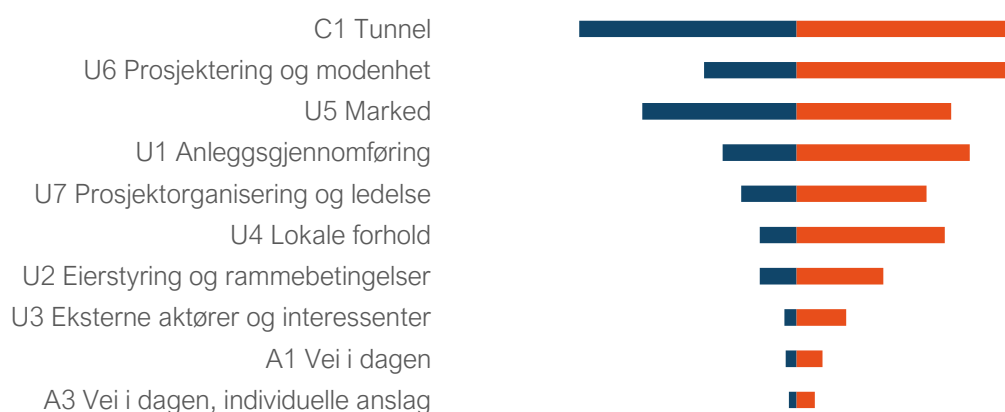
Figur 13 - Tornadodiagram for alternativ K4+ fra vår uavhengige usikkerhetsanalyse. Figuren rangerer de ti elementene som bidrar mest til den totale kostnadsusikkerheten. Blå farge viser potensial for kostnadsreduksjon (P10), mens oransje farge viser potensial for kostnadsøkning (P90), relativt til basiskostnaden.
