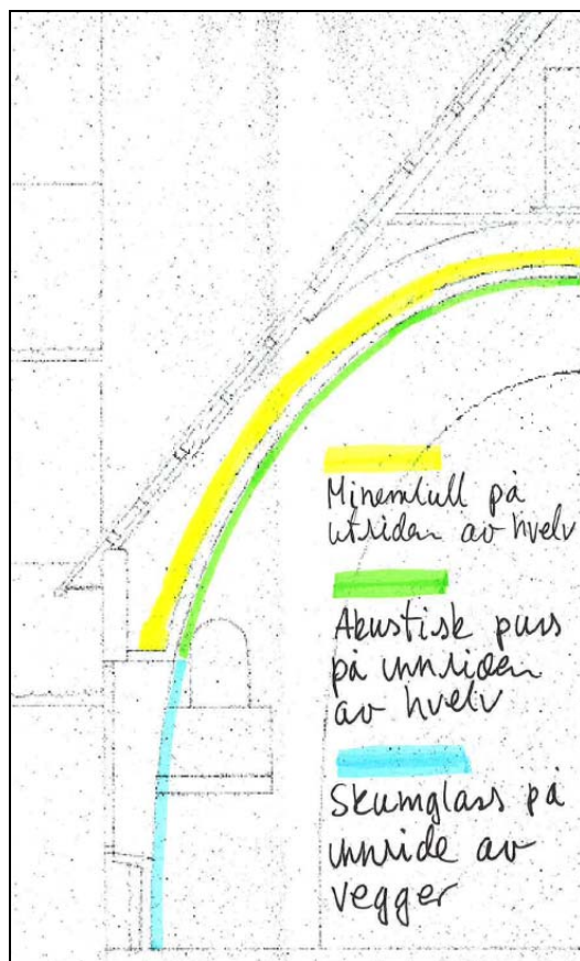
Figur 5: Illustrasjon av foreslått strategi for etterisolering.
