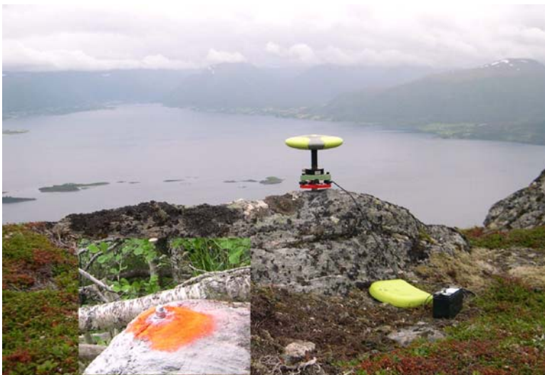
Figur 8: Måling av bevegelse med bruk av GPS. Fra Oppstadhornet i Møre og Romsdal.
