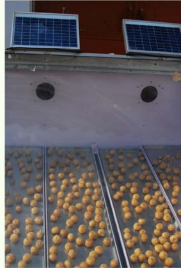
Solcellepanel til tørking av frukt i India
