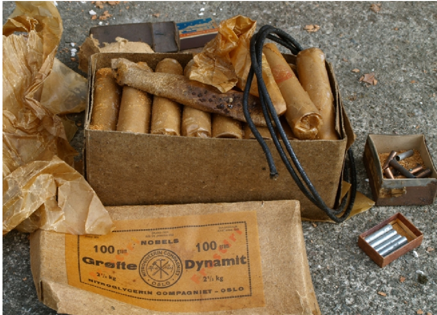
Groftedynamitt, tennere og kruttlunte. Bilde utlevert fra FOH, tatt av EOD operatør
