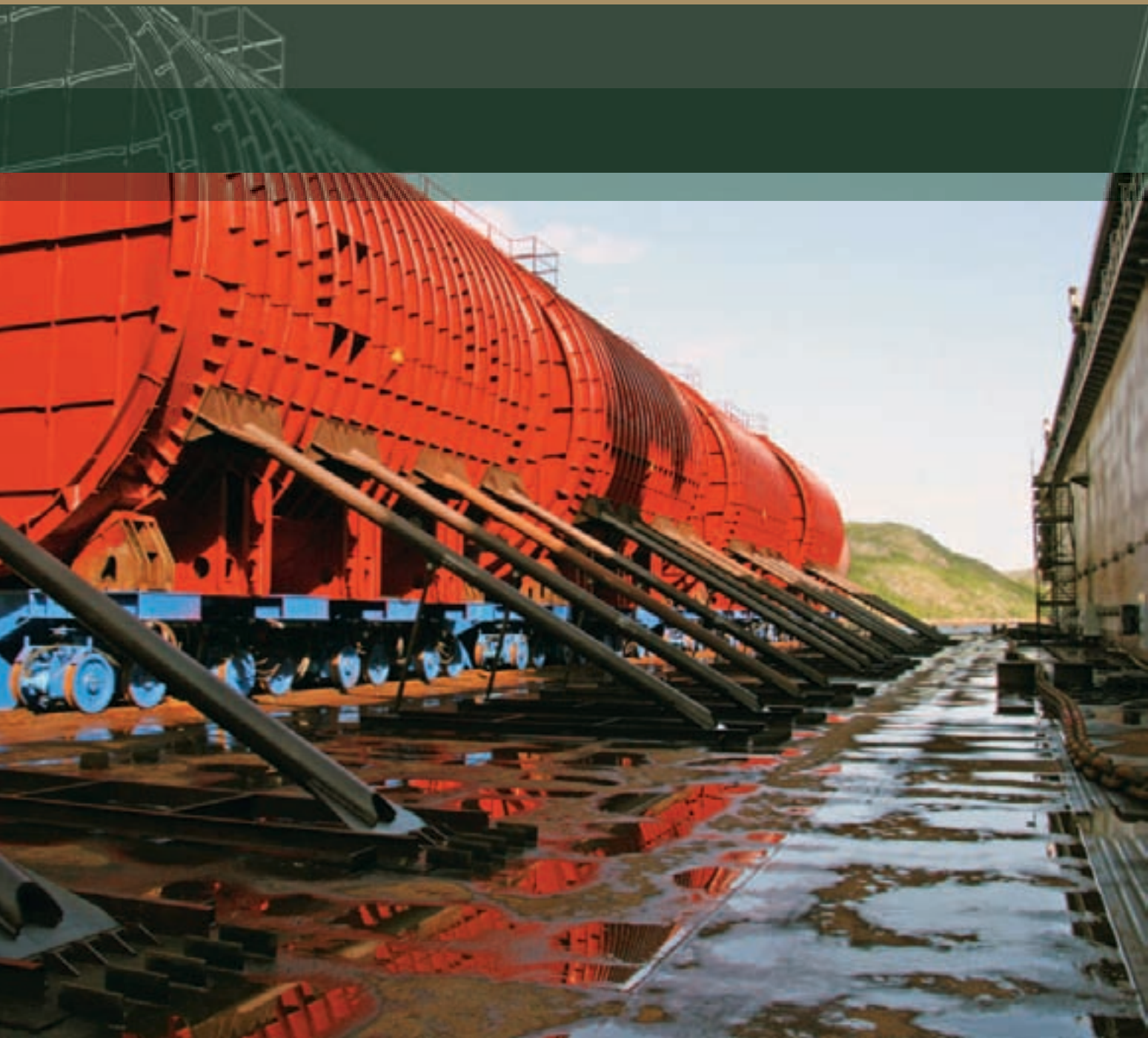
Готовые к транспортировке в губу Сайда реакторные отсеки. Фото: Государственное управление Норвегии по ядерной и радиационной безопасности Фото на обложке: Погрузка подводной лодки № 291 на транспортное судно «Траншельф» 4 сентября 2006 г. перед транспортировкой на судовой № 10. Фото: НИИ Министерства обороны Норвегии
