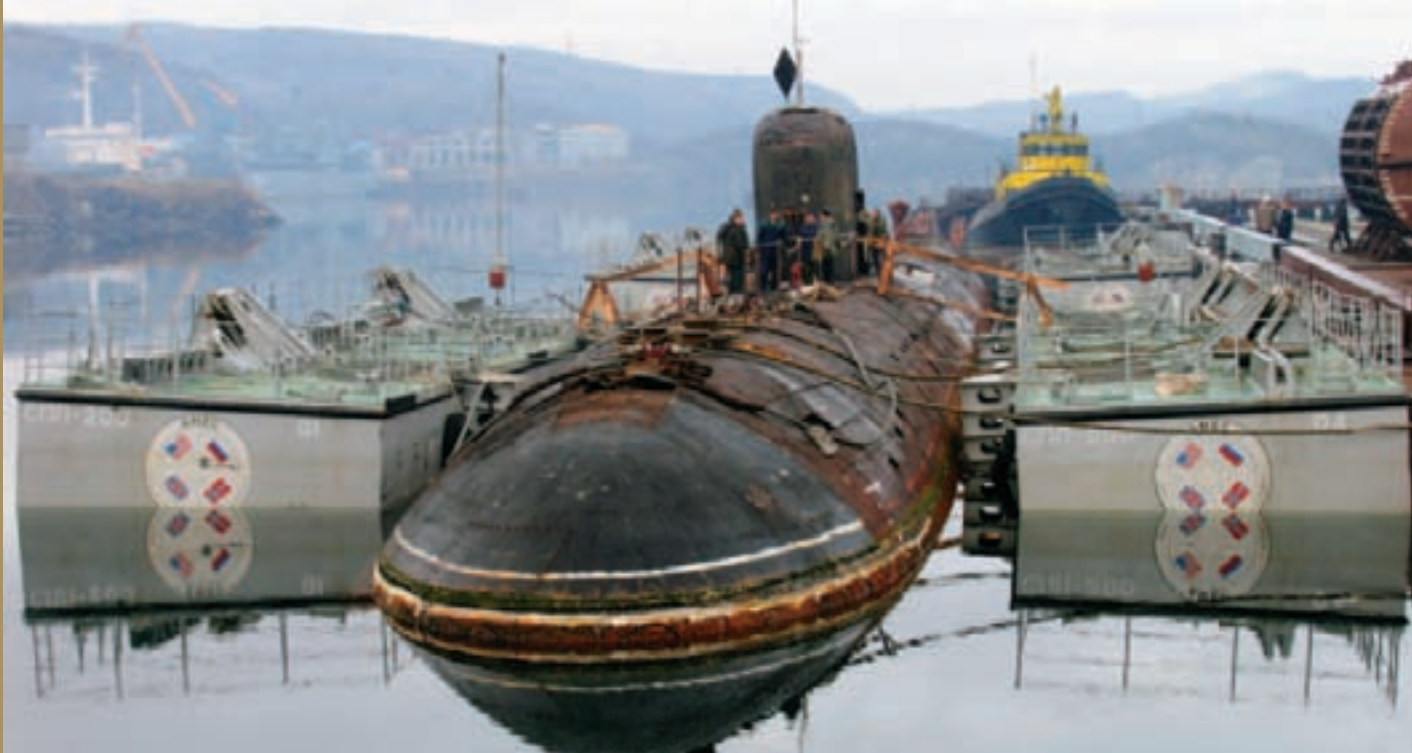
Подлодка № 291, снабженная понтонами на судовой верфи «Нерпа». Фото: судовой верфи «Нерпа».
