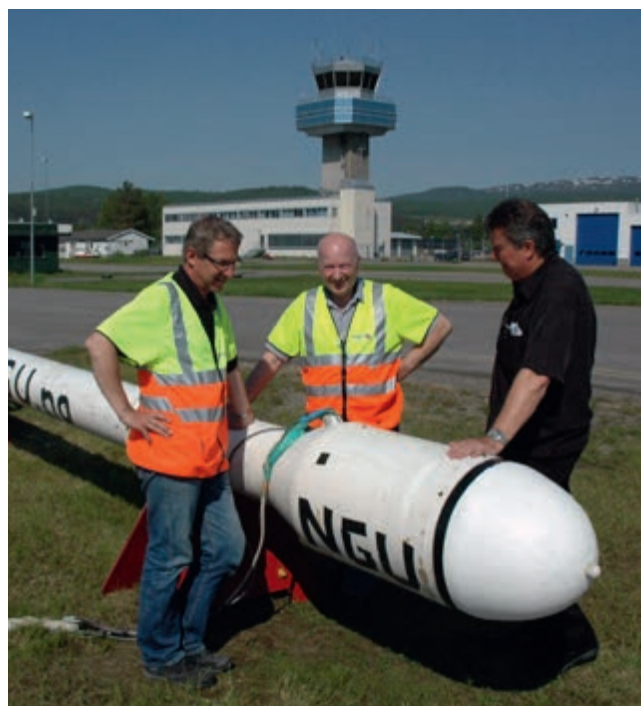
Instrumenter for måling av magnetiske og elektromagnetiske egenskaper i berggrunnen er plassert i en beholder som henger 30 meter under helikopteret. Foto: NGU
