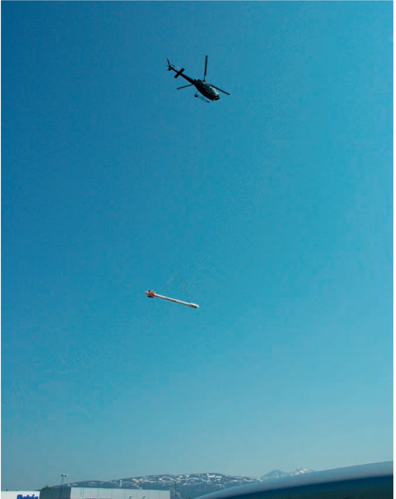
NGU utfører målinger av geofysiske egenskaper i berggrunnen fra helikopter som flyr lavt over terrenget. Foto: NGU
