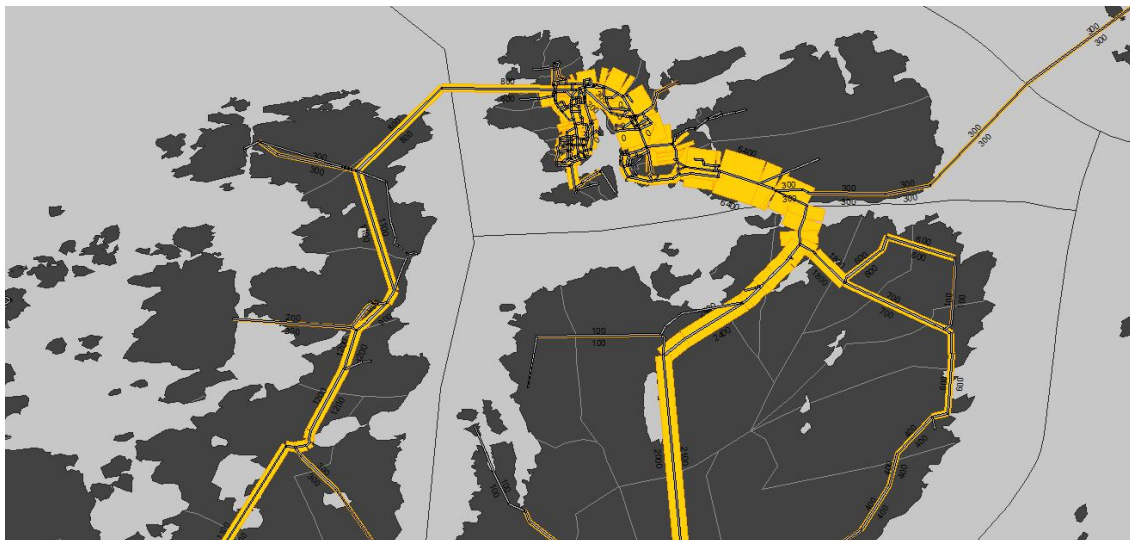
Figur 6.7 Trafikkvolumer (VDT 2010) i Atlanterhavstunnelens influensområde med dagens bompengesatser (dvs. fullpris for lettbil på 76 kr per passering)
