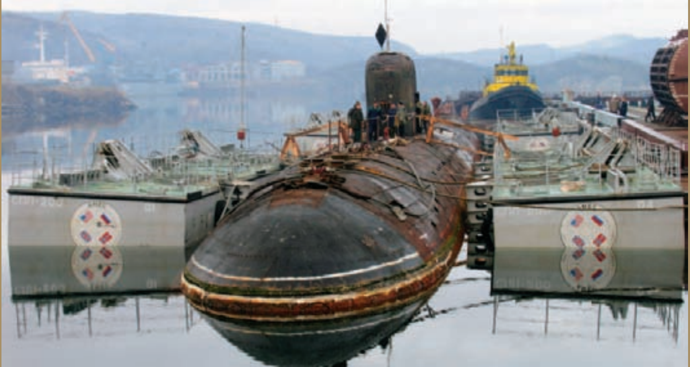
Ubåt 291 fortøyd med pongtonger påmontert ved Nerpa skipsverft. Foto: Nerpa skipsverft.
