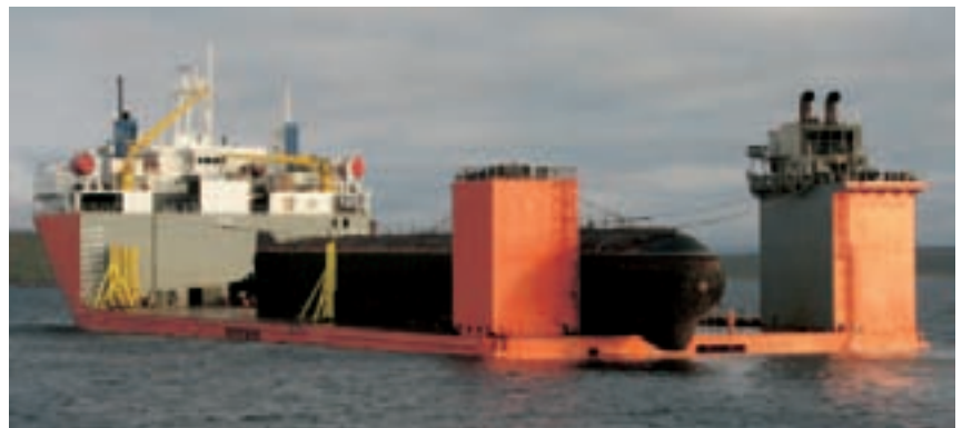
Ubåt 291 på dekket til Transshelf, klar for innfesting. Foto: FFI.
