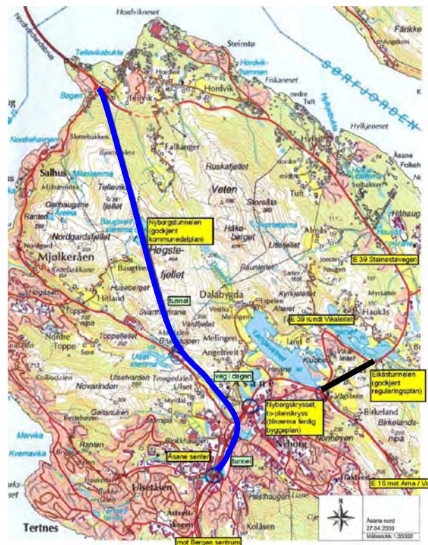
Figur 10.5 Illustrasjon som viser Nyborgtunnelen med kobling mot E39/E16 ved Nyborg. Eksisterende E39 går i en sløyfe via Hylkje i øst. Eikåstunnelen (vedtatt) vil her løse trafikk-sikkerhetsproblemer ved Vikaleitet. Det er i dag klare randsone- og trafikk-sikkerhetsproblemer langs dagens E39. I gjeldende kommuneplan (og høringstiltak for rullering) ligger inne nye utbyggingsområder på Almås/Hylkje.
