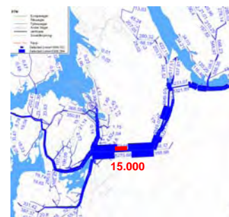
Figur 10.3 Illustrasjon. "Selected-links"-analyse i 2010-situasjon for Ringveg øst, variant til Fjøsanger i sør. Analysen viser hvor beregnet 15 tusen kjt fordeler seg på begge sider av snittet.
