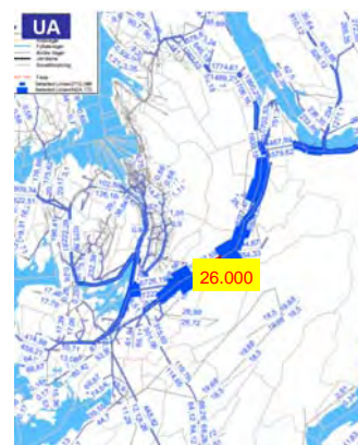
Figur 10.2 Illustrasjon. "Selected-links"-analyse i 2040-situasjon for Ringveg øst, variant til Hop i sør (K3). Analysen viser hvor beregnet 25-26 tusen kjt fordeler seg på begge sider av snittet.
