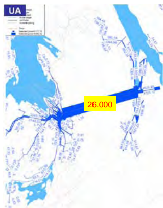
Figur 10.1 Illustrasjon. "Selected-links"-analyse for Arnatunnel til Nygårdstangen i 2040-situasjon (K4). Analysen viser hvor beregnet 26 tusen kjt fordeler seg på begge sider av snittet.
