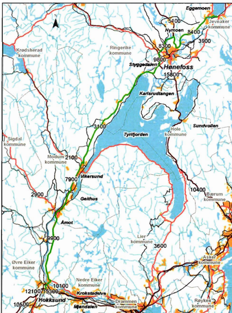
Figur 17: Trafikktall i 2009 på planstrekningen. Tallene kommer fra trafikktellinger. Det kan forekomme noen avvik i forhold til de beregnede trafikktallene fra transportmodellen.
