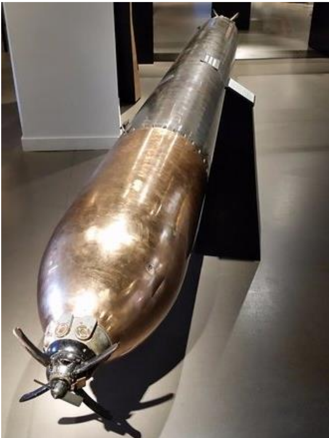
G7e(TIII) torpedo med type Kb krigshode og type Pi2 tennapparat (kilde: Internett).
